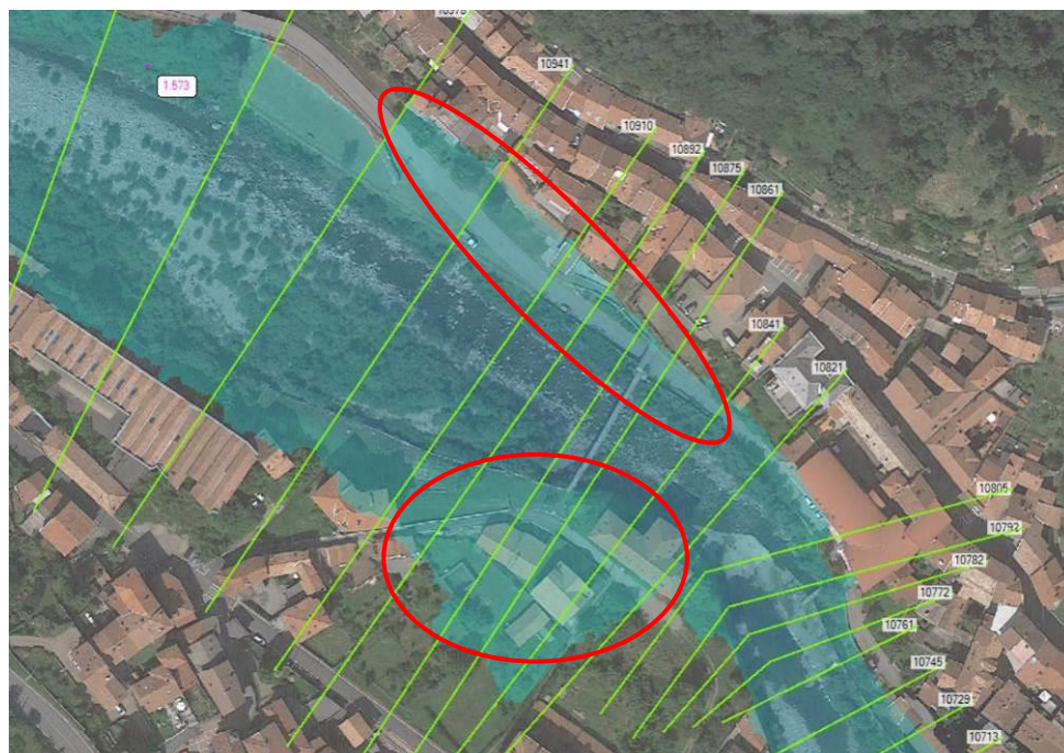
Figura 44 - Stato di fatto per Tr 200 anni. Dinamiche di esondazione del Sessera nel concentrico di Coggiola
