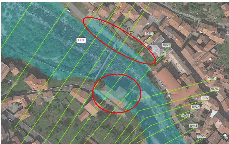
Figura 43 - Stato di fatto per Tr 20 anni. Dinamiche di esondazione del Sessera nel concentrico di Coggiola
