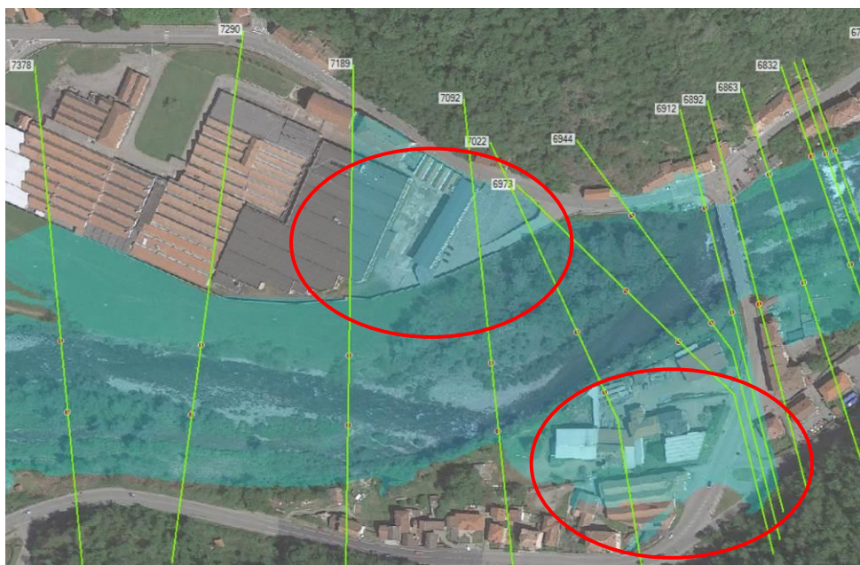
Figura 28 – Stato di fatto per Tr 200 anni. Dinamiche di esondazione del Sessera a monte del ponte di Pianceri in Comune di Pray per effetto principale del rigurgito dettato dall'impalcato
