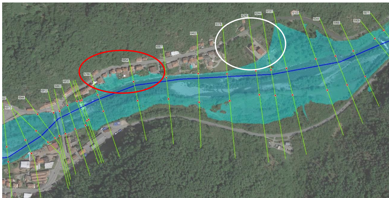
Figura 72 - Stato di PROGETTO per Tr 200 anni. Dinamiche di esondazione del Sessera in Comune di Pray a valle della traversa a sostegno del ponte di Pianceri ed evidenza della risoluzione delle criticità per esondazione in sinistra idraulica
