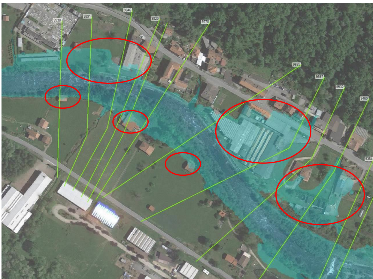
Figura 39 – Stato di fatto per Tr 200 anni. Dinamiche di esondazione del Sessera a valle del cimitero di Coggiola con rigurgito e sormonto dei livelli idrici della passerella pedonale ed allagamento di alcune abitazioni e stabilimenti in sinistra e destra idraulica
