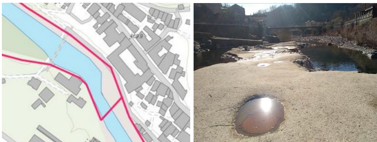
Figura 41 – Tracciato delle condotte Co.R.D.A.R. in Comune di Coggiola. Attraversamento della condotta da destra a sinistra orografica in corrispondenza della soglia funzionale alla derivazione idroelettrica. Pozzetti della fognatura rilevati sulla sagoma della traversa
