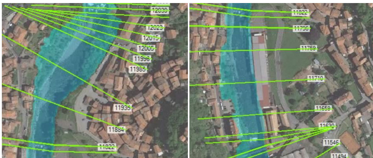
Figura 61 - Stato di PROGETTO per Tr 200 anni. Dinamiche di esondazione del Sessera a monte del ponte condotta ed evidenza della risoluzione delle criticità
