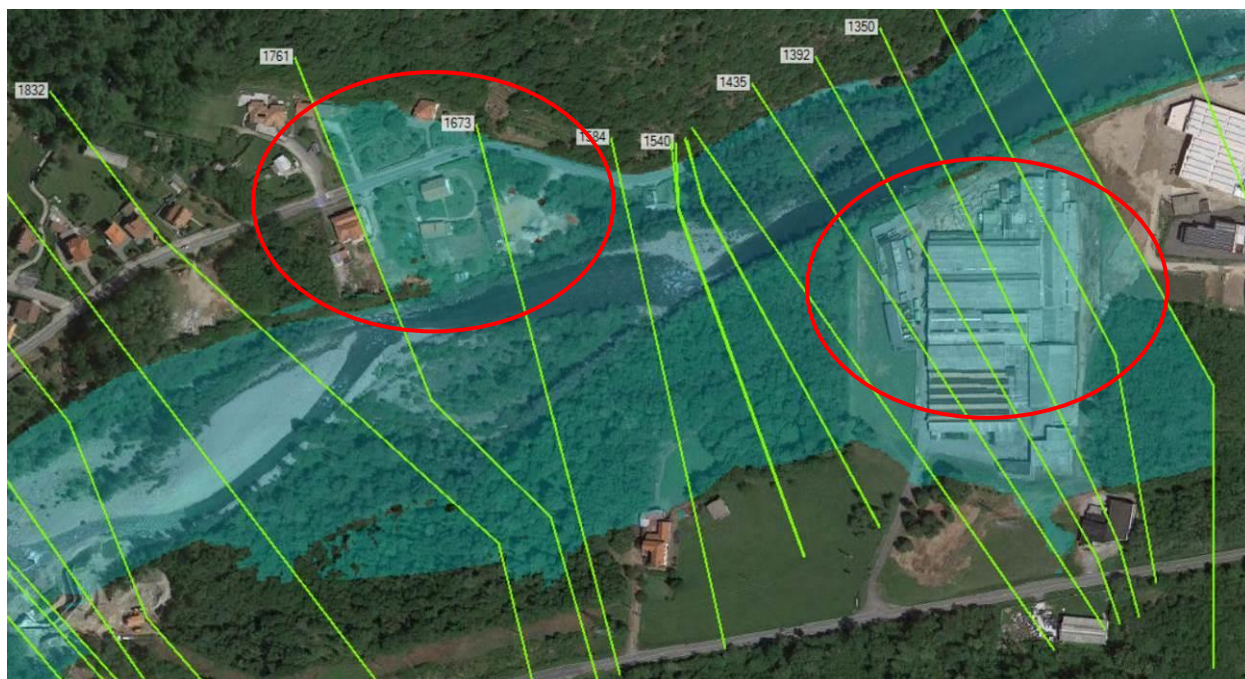
Figura 16 – Stato di fatto. Dinamica di esondazione in sinistra e destra idraulica tra le pk 1+760 e 1+350 con evidenza dell'allagamento di alcune abitazioni in sinistra e del fabbricato a monte del lanificio Colombo
